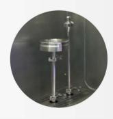
在线环境监测系统集成度 高,采样管路可在线灭菌, 报表独立生成;
